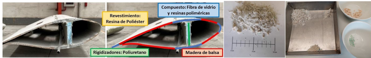
Figura 1: Pala de aerogenerador: Sección genérica con identificación de componentes; Materiales resultantes de la trituración de la pala de aerogenerador (TPA); Componentes separados del TPA.
